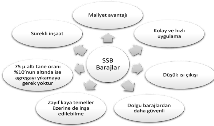
Şekil 3-19. Silindirle sıkıştırılmış beton barajların avantajları
